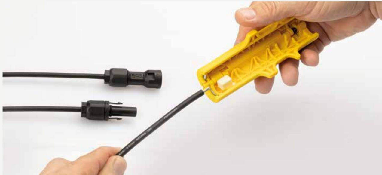
Tope longitudinal de 8,5 y 15 mm, para la conexión de conectores fotovoltaicos convencionales
